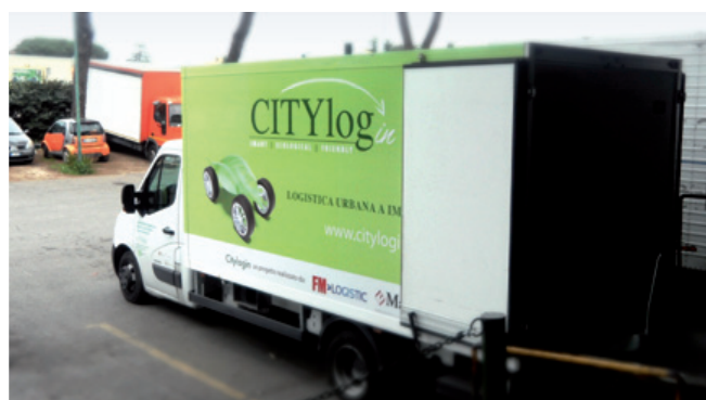
Veicolo bimodale da 35 q.li in fase di carico: diesel all'esterno del Tridente, elettrico all'interno.
